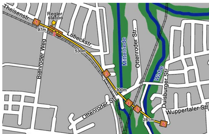
Abbildung 1: Schematische Darstellung des Verlaufs der einzuziehenden Leitung
